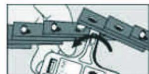
Pri demontáži pootočte dva za sebou nasledujúce nity o uhol 90°, medzi články vložte nástroj (prípadne skrutkovač) a otočením články vytiahnite z nitov. Pri spájaní použite opačný postup.
